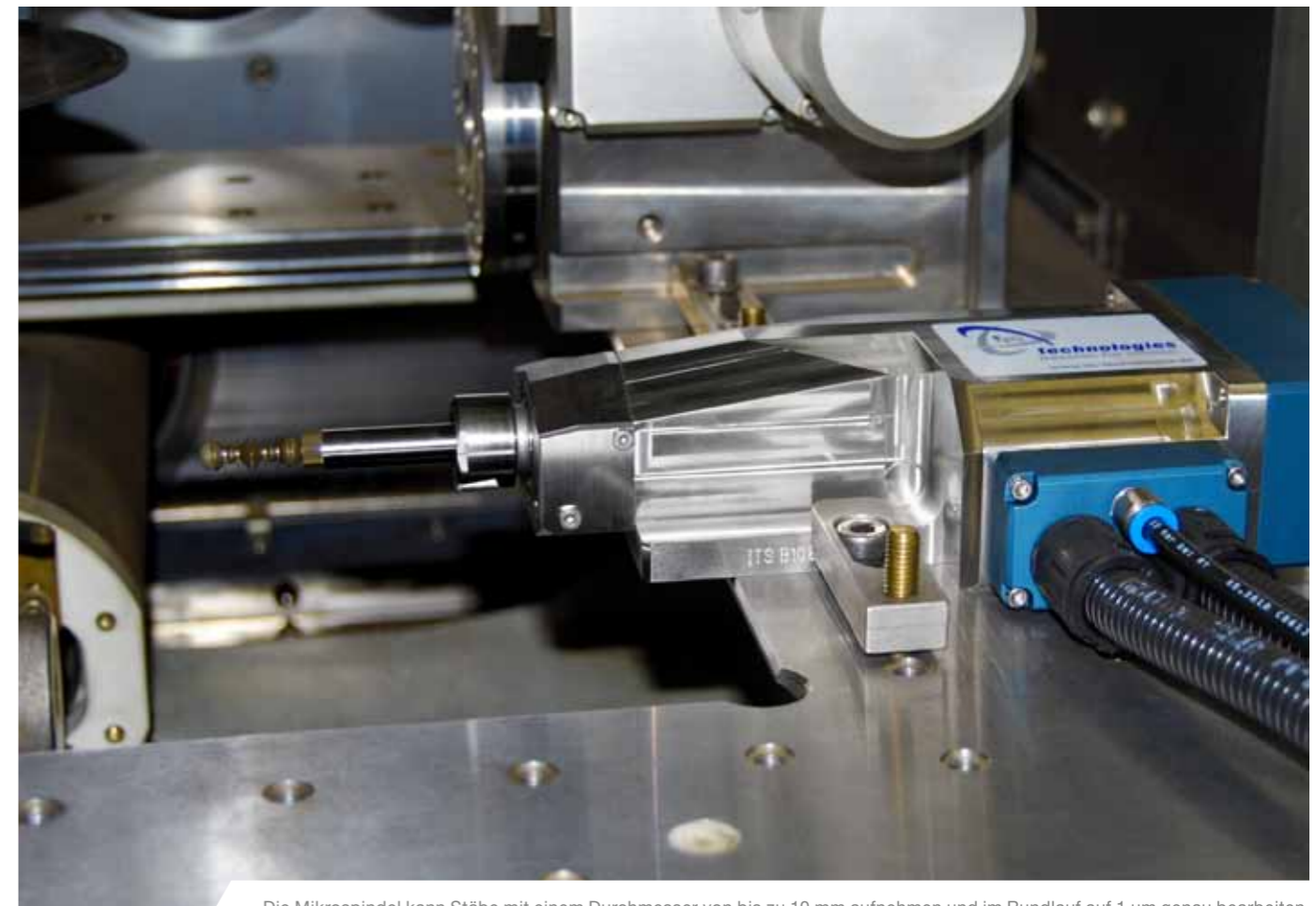
Die Mikroschindel kann Stäbe mit einem Durchmesser von bis zu 10 mm aufnehmen und im Rundlauf auf 1 µm genau bearbeiten.
